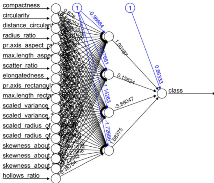
Figura: Informações (18) sobre medidas de silhuetas de carros. Saída é um carro normal ou um ônibus. Taxa de acerto por volta de 50%.
